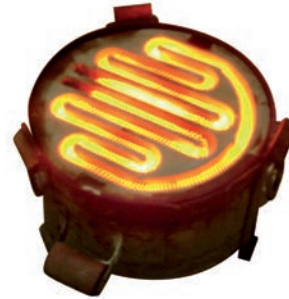
चित्र 14.11 (a) खाना पकाने में उपयोग आने वाला कोई विद्युत तापक (हीटर)
