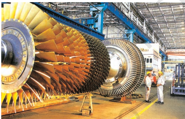
चित्र 6.10 – बी एच ई एल (हैदराबाद) में गैस टरबाइन रोटार का समायोजन
